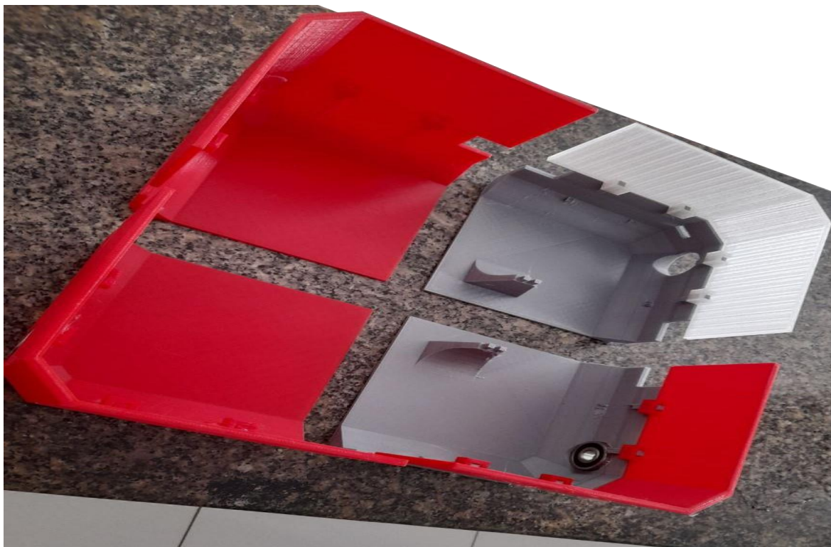
Figura 18 - Chassi impresso em oito partes
