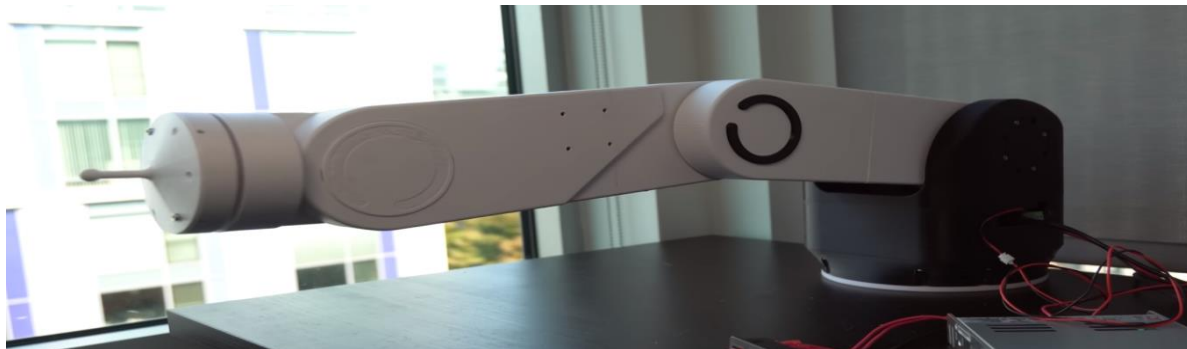
Figura 11 - Braço robótico feito na impressora 3D
